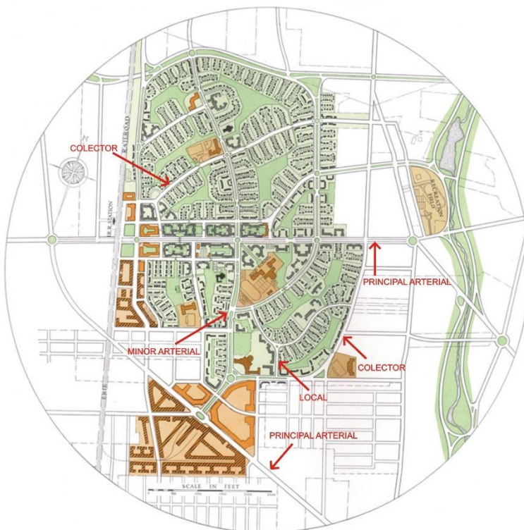
Obr.3 – Funkční klasifikace a jejich vzájemné vztahy (Zdroj: Regional Plan Association, http://www.rpa.org/images/FRP_Radburn.jpg )
