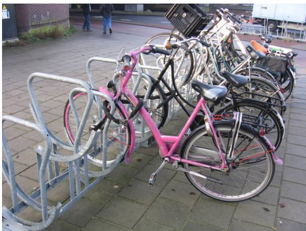
Obr. 42: Kapacitní stojany s jednoduchou instalací (Amsterdam). Podobný princip parkování kol je použitý i na parkovišti pro 5000 kol u hlavního nádraží v Amsterdamu. Zdroj: Sperat
