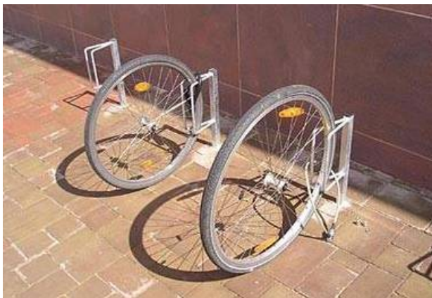
Obr. 3: Nevhodné stojany pro cyklisty. Zdroj: The Danish Cyclists Federation, 2008
