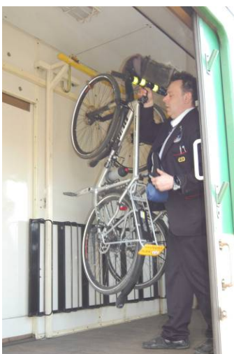
Obr. 81: Uchycení kol ve služebním voze. Zdroj: Žáková
