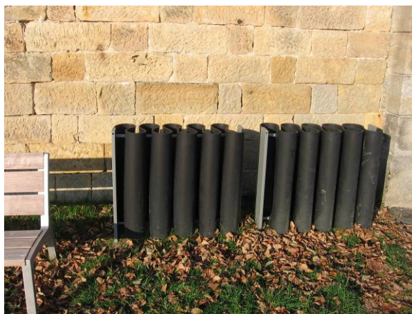
Obr. 39: Naprosto nevhodný stojan z důvodu nemožnosti zamčení kola, kolo ve stojanu nedrží. (Chodovice) Zdroj: Sperat
