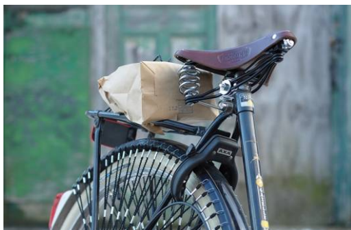
Obr. 44: Zámek zadního kola jako doplněk k zámku, který zamyká přední kolo a rám ke stojanu, tento zámek je velmi rozšířený např. v Nizozemsku. Zdroj: www.cyclingchainring.com
