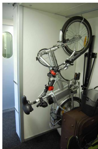
Obr. 82: Místo pro uložení kol v jednotce Pendolino. Zdroj: Žáková
