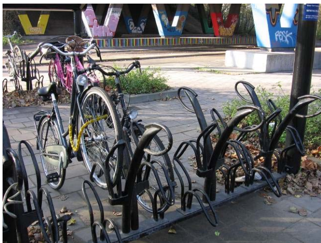
Obr. 31: Oboustranný stojan s výškovým odsazením předního kola je velmi kapacitní. Zdroj: Sperat
