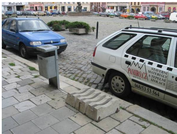
Obr. 37: Nevhodný stojan z důvodu kotvení a nemožnosti uchycení jízdního kola. Zdroj: Galatik
