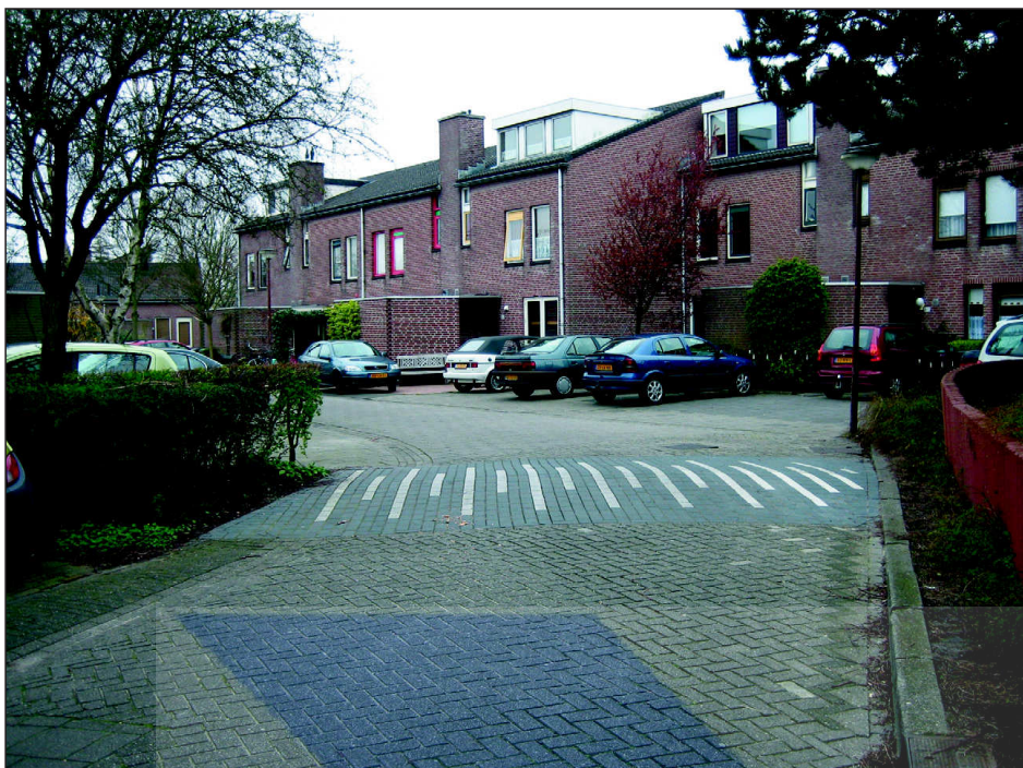
Obr.16: Příklad zpomalovacího prahu v obytné zóně. (Alkmaar, Nizozemsko).
