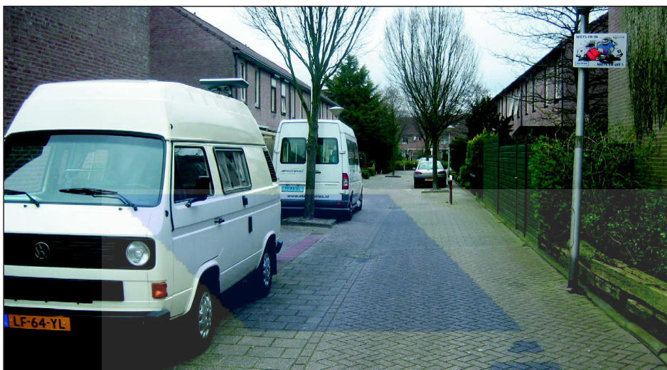
Obr.20: Příklad šikany v obytné zóně vytvořené vystřídáním parkovacím stáním (Lisse, Nizozemsko).
